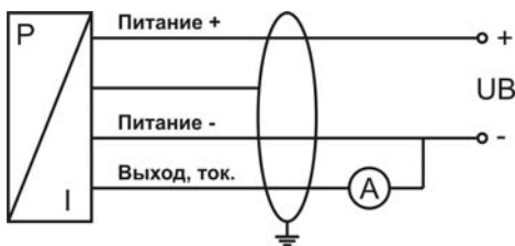
Рисунок В.3. Двухпроводная схема включения (токовый сигнал)
